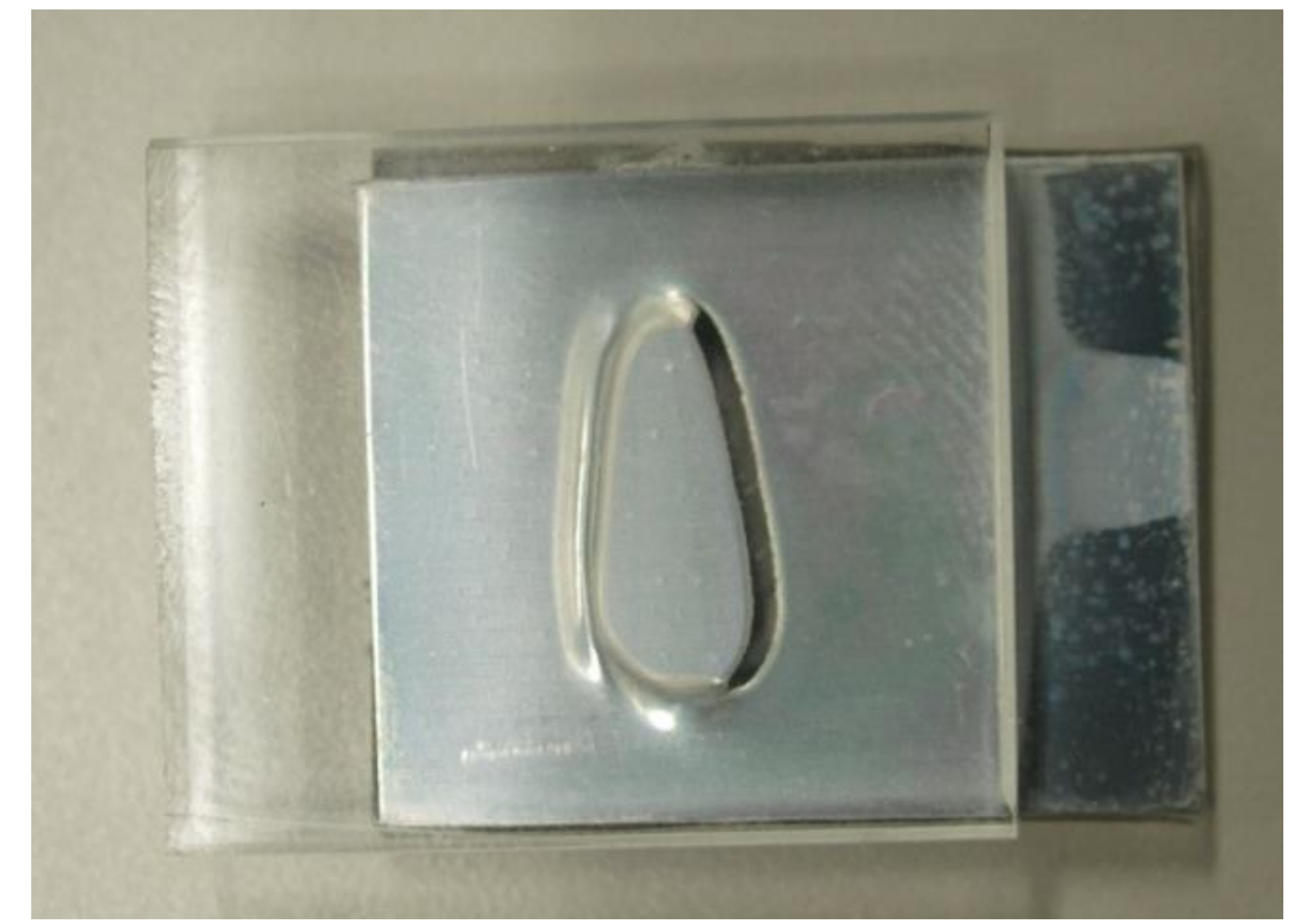
アルミニウムとアクリルの接合例
