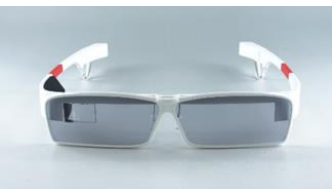
写真1 音を可視化した画像等を表示する透過式的眼鏡型情報端末「ヘッドマウントディスプレイ(HMD)」
