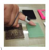
フィルムを用いており、皮膚を伝搬する振動を検出し、振動情報を読み取っている。
