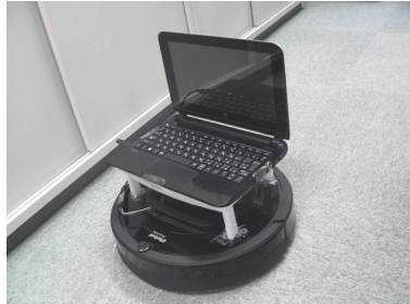
既設ロボットを用いた接触コミュニケーションロボットの試作
