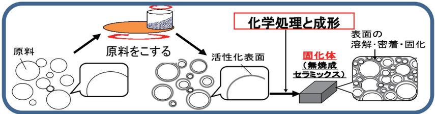
セラミックス原料粒子の表面をメカノケミカル処理により化学反応が起きやすい状態に処理 (活性化) し、反応溶液と混合することで、粒子同士を化学反応させ結合し固める技術、すなわち、焼成工程が不要となる新しいセラミックス製造技術を開発しました。
