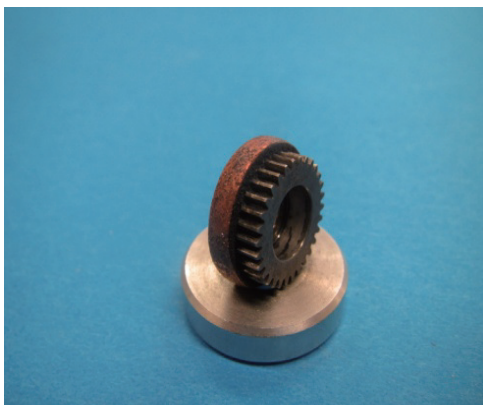
図1. 遠心力混合粉末法にて作製したCu/ダイヤモンド傾斜機能砥石
