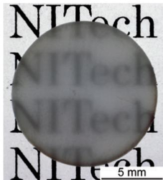
結晶配向電解質の写真。光学的一軸性結晶が垂直に集合して透光性が発現。
